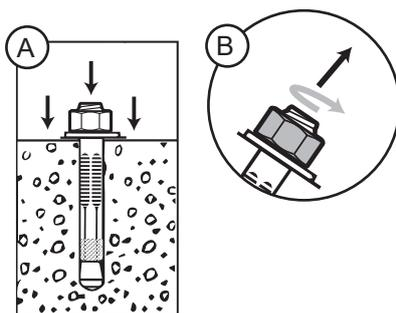
l'écrou au maximum à l'aide d'une clé ou d'une douille. Lorsque vous serrez le bouclier, il se plie vers l'extérieur, créant ainsi un ancrage qui offre une sécurité supplémentaire à votre appareil.
