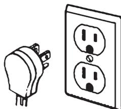
Prise de courant correctement polarisée et mise à la terre
