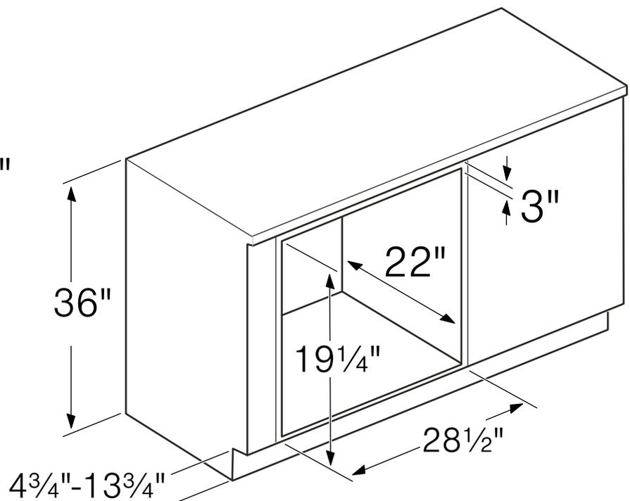
**Avis :** La base de l'armoire doit être plate et capable de supporter un poids minimal de 64.1 kg (141.32 lbs)
