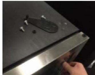
5. Soulevez la porte et retirez-la de la charnière inférieure et placez-la sur une surface rembourrée pour éviter le dommage et les rayures.
